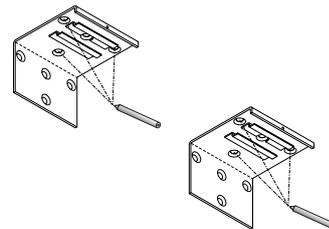
Befestigungswinkel in gewünschter Höhe an die Wand oder Decke halten und Bohrlöcher markieren, Löcher (für die Befestigungswinkel) den Markierungen entsprechend bohren und Dübel einsetzen.
