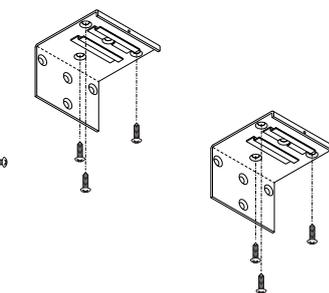
Položte upevovací držáky na stěnu nebo strop a připevněte je lehké šrouby. Srovnejte držáky do vodorovné polohy. Dotáhněte šrouby.
