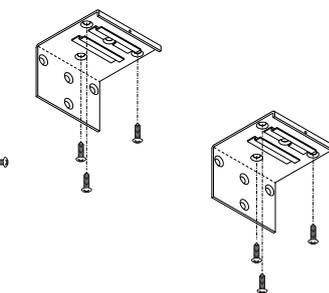
Befestigungswinkel an die Wand oder Decke halten und mit Schrauben befestigen. Lage der Befestigungswinkel mit Hilfe einer Wasserwaage regulieren. Schrauben anziehen.
