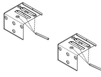
Umístěte upevovací držáky v požadované výšce na stěnu nebo strop a označte otvory pro hmoždinky (viz. obr.). Vyvrtejte otvory a vložte hmoždinky.
